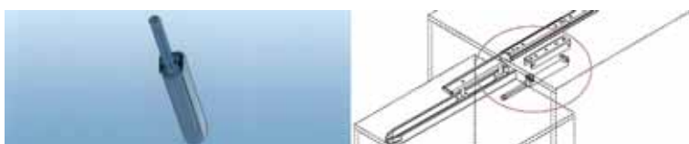
Softstopp demper voor Box geleider - indien de diepte > 700 mm of de breedte > 400 mm dan dient u 2 dempers te gebruiken
